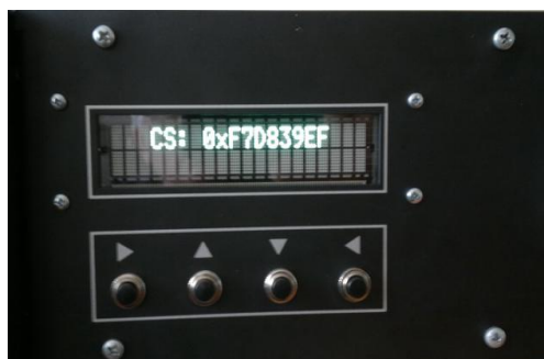
Рисунок 4 – Определение контрольной суммы встроенного ПО MICROGAZ
